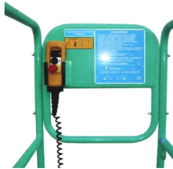
Handsteuerung mit Not-Aus
